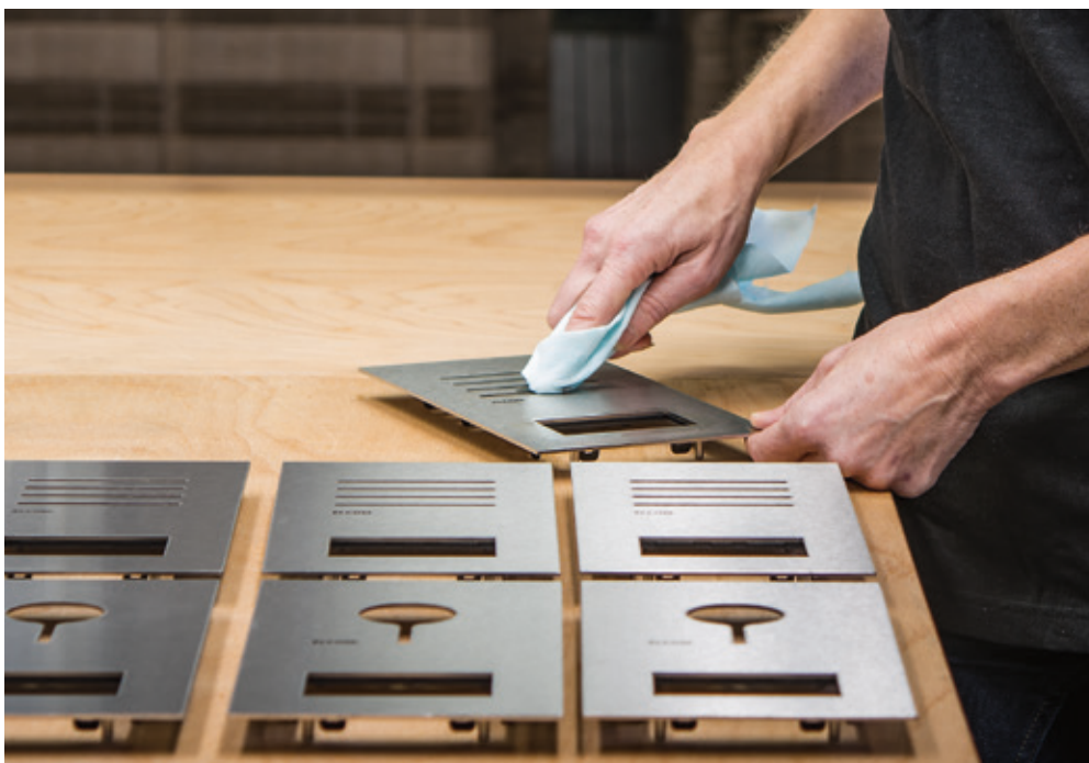
Abb.: Frontblenden von Elcom nach der Laserung.
